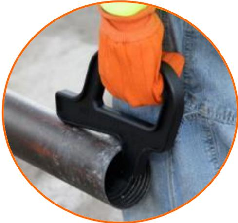
*Manipulador de Tuberías (Rod Lifter)*
